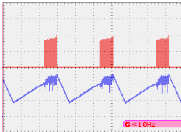
图 7. 过压保护 蓝: VIN, 红: DRVSW
